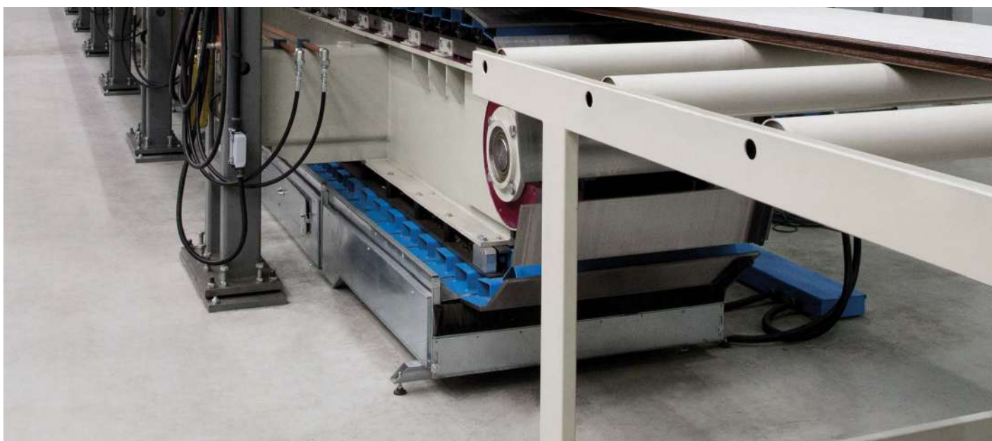
La moderna, controllata dal computer linea tecnologica di lunghezza 200 m che produce con sistema continuo pannelli per portoni sezionali - nella foto: la fase di profilatura del pannello.
