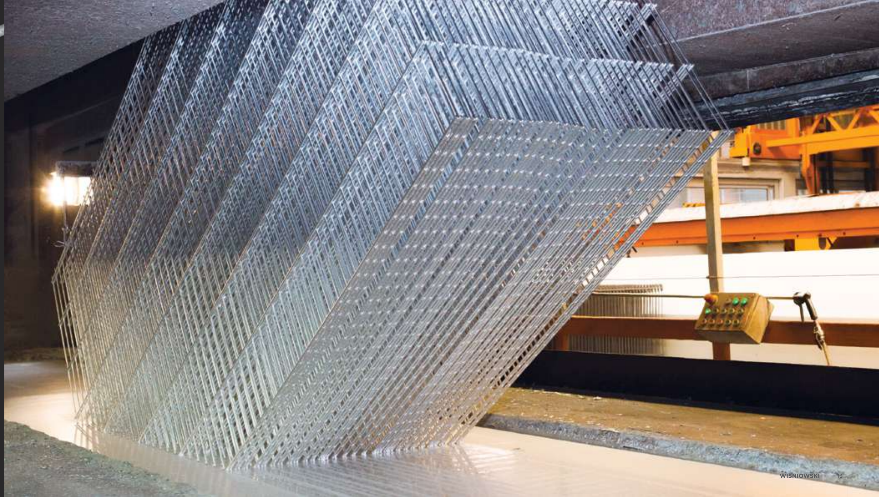
Pannello in rete protetto tramite: zincatura a caldo
