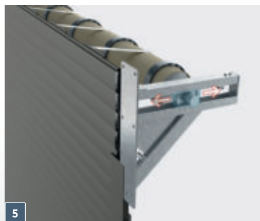
5 Albero di avvolgimento mobile – durante l'avvolgimento della serranda, cambia la sua posizione rispetto alla parete dell'architrave, assicurando così che le guide del manto in movimento siano mantenute nell'asse.
