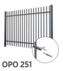
I moduli OPO 251 sono moduli industriali, realizzati in profilati chiusi 25 x 25 [mm], saldati a sovrapposizione dalle traverse in profilato 40 x 27 [mm].
