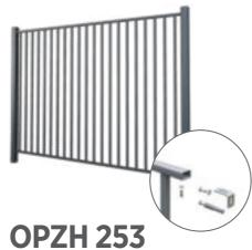
I moduli OPZH 253 sono moduli industriali, realizzati in profilati chiusi 25 x 25 [mm], saldati a sovrapposizione dalle traverse in profilato 40 x 27 [mm].
